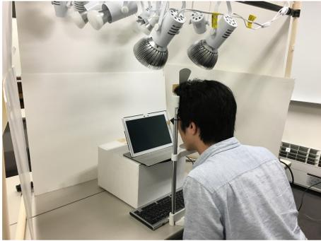
図4 実験装置内部の様子（実験中は装置全体が暗幕で覆われている）
