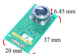
図 3 16 \times 16 画素の赤外線センサアレイ
